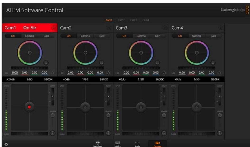
Программная панель позволяет управлять моделями Blackmagic Pocket Cinema Camera 4K и 6K с видеомикшера ATEM Mini
