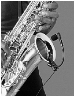
INSTALLAZIONE SU SASSOFONO FIGURA 4
