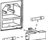
Paso 1: Abra el portafusibles del panel trasero con un destornillador adecuado.
