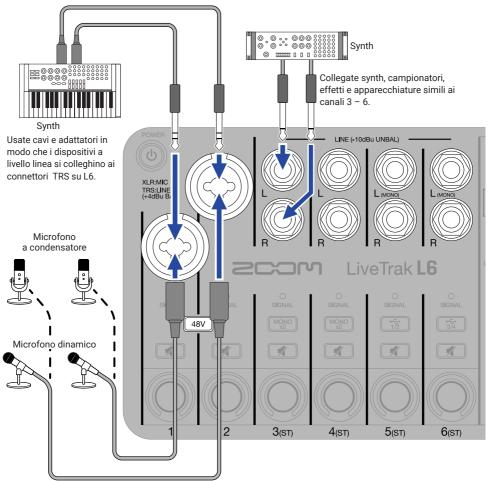
Collegate i microfoni dinamici e a condensatore usando i connettori XLR.
