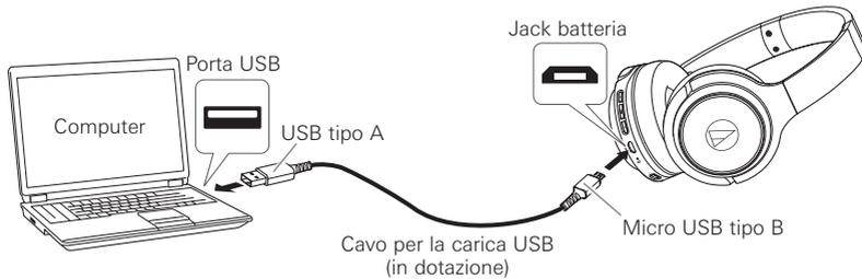
2. Collegare il cavo per la ricarica USB in dotazione (USB tipo A) al computer per iniziare la ricarica.
