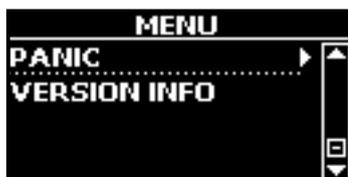
2. Premere il bottone [▶] per eseguire la funzione. I messaggi "All notes off" e "Reset All Controllers" saranno trasmessi al generatore sonoro del VIVO S10 e su tutti i canali MIDI di un generatore sonoro eventualmente collegato.
