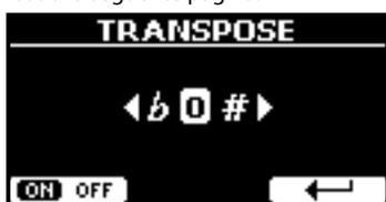
2. Usare la manopola [DATA ENTRY] o i bottoni [◀] [▶] per regolare il livello di trasposizione.
