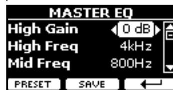
1. Usare i bottoni [▲], [▼] per selezionare il parametro ed usare la manopola [DATA ENTRY] o i bottoni [◀] [▶] per regolare il valore.
