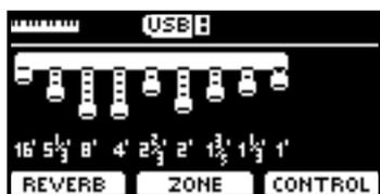
Sul pannello dello strumento, sotto o sopra ciascuno dei draw-fader, sono elencati i piedi utilizzati per ogni tipo di organo.
