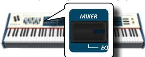
1. Premere il bottone [MIXER] per assegnare i 9 draw-faders alla regolazione del volume o/e riverbero di ogni parte della tastiera.
