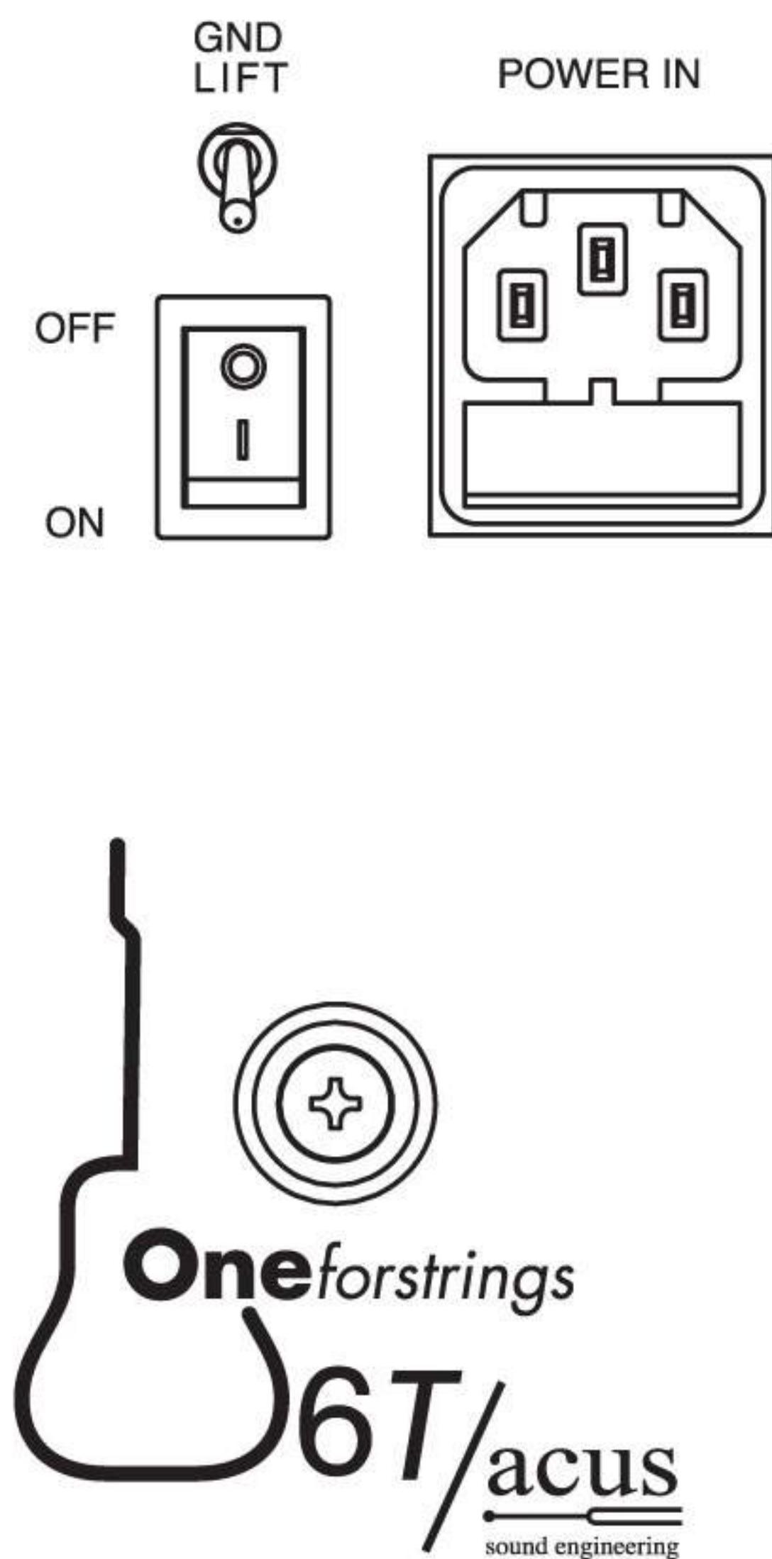
**16- GND LIFT:** interrupteur de la mise à la terre du circuit électrique. Inverser la position en cas de ronflements générés par le réseau d'alimentation électrique.
