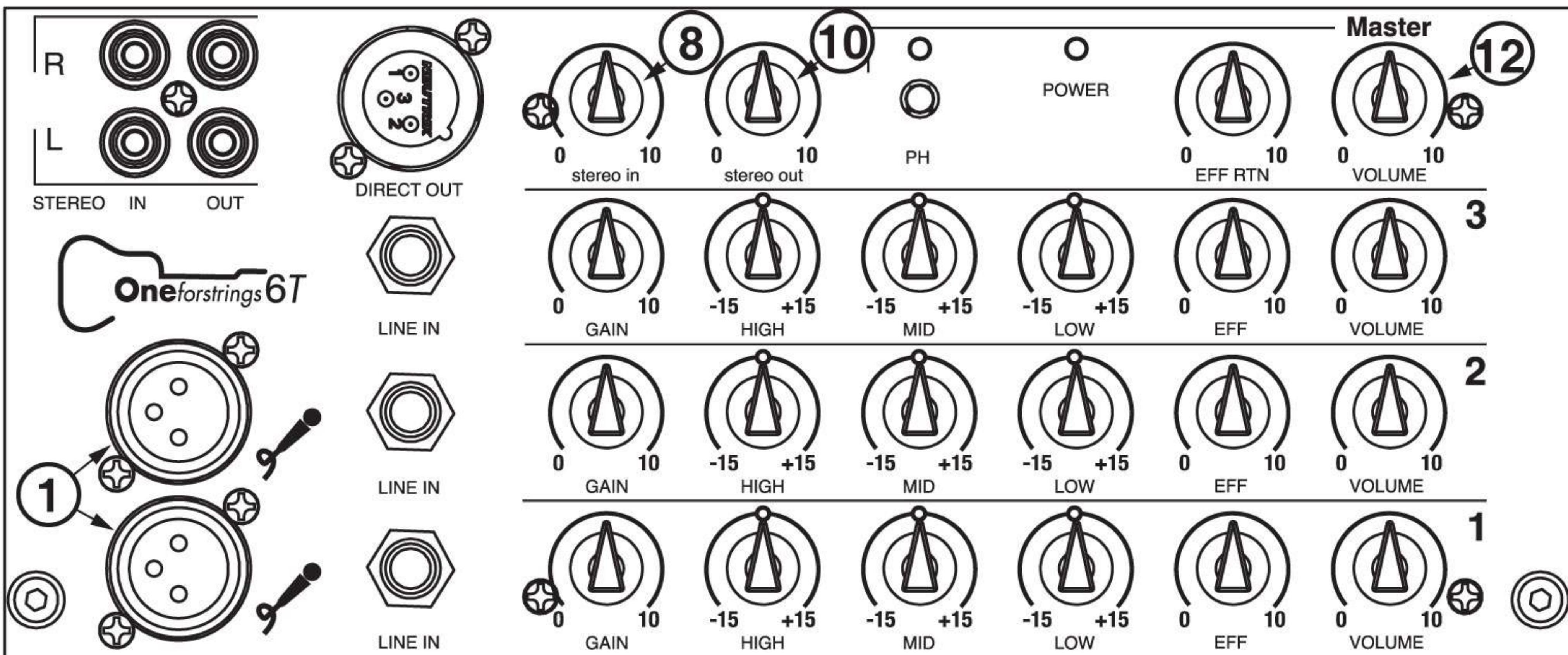
**1-MIC IN:** ingresso microfonico bilanciato elettronicamente con impedenza di ingresso di  $1\text{k}\Omega$ , ingresso adatto a tutti i tipi di microfoni.
