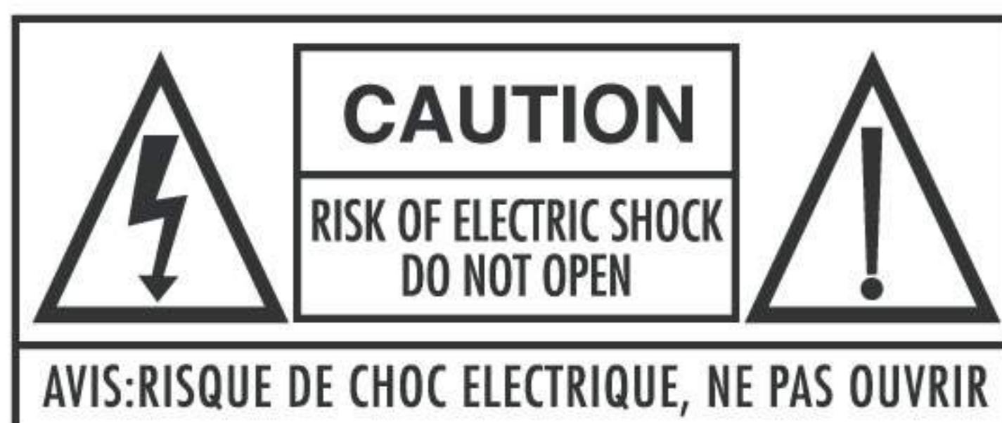
IL SIMBOLO DEL LAMPO CON LA FRECCIA ALL'INTERNO DI UN TRIANGOLO EQUILATERO INDICA LA PRESENZA DI ALTA TENSIONE, SENZA ISOLAMENTO ELETTRICO, PERICOLOSA. ALL'INTERNO DELL'APPARECCHIO LA TENSIONE PUO' ESSERE DI INTENSITA' SUFFICIENTE DA PROVOCARE RISCHI DI SHOCK.
