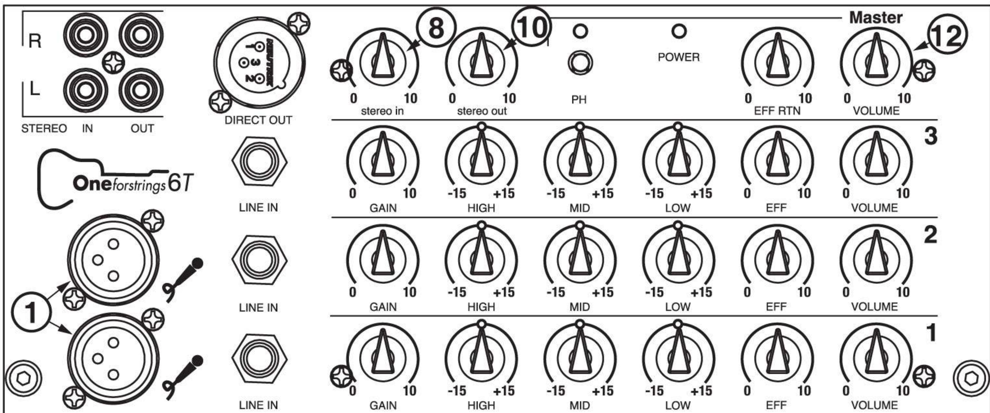
**1-MIC IN:** entrée microphonique à équilibrage électronique avec impédance d'entrée de  $1\text{ k}\Omega$ , entrée adaptée à tous les types de microphones.
